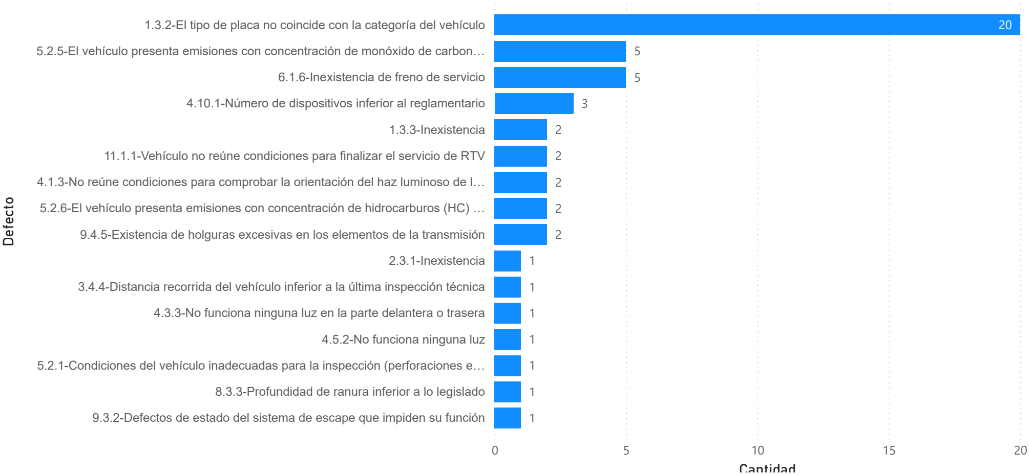
Principales defectos graves y peligrosos identificados en la IVE para tipo de vehículo bicimoto
